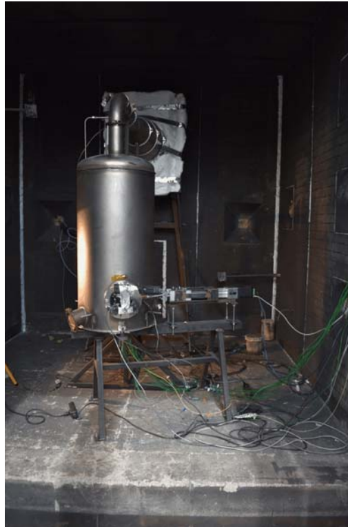
Abbildung 2: Messhaube mit Anpassungen an der Luftführung. Hier dargestelltes Setup für Nagelpenetration.
