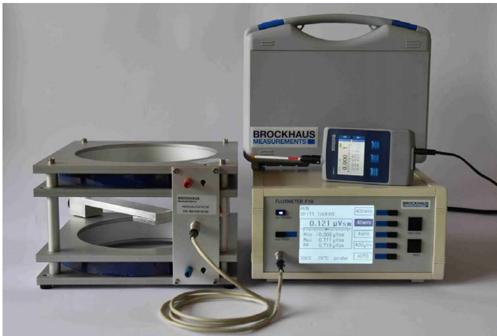
Abbildung 2: Messplatz zur Messung der magnetischen Leitfähigkeit, bestehend aus Gaußmeter, Flussmeter und Helmholtz-Spule. Während der Versuchsdurchführung wird innerhalb einer Helmholtzspule das magnetische Moment M ermittelt.
